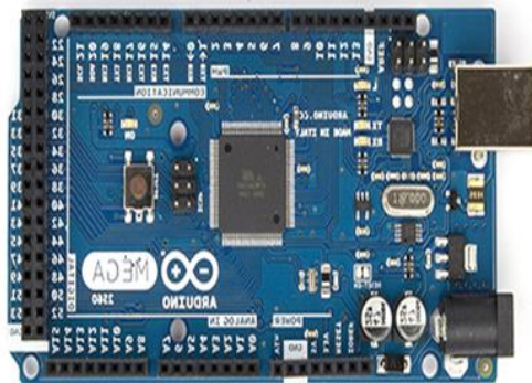
شکل (۷) برد الکترونیکی آردینو مدل مگا ۲۵۶۰ در دستگاه نشاءکار
