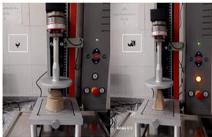
شکل (۲) گلدان‌های تجدیدپذیر در آزمون فشار الف) هرم با قاعده مربعی شکل، ب) مخروط ناقص Figure (2) Renewable pots in the pressure test a) pyramid with square base, b) incomplete cone
