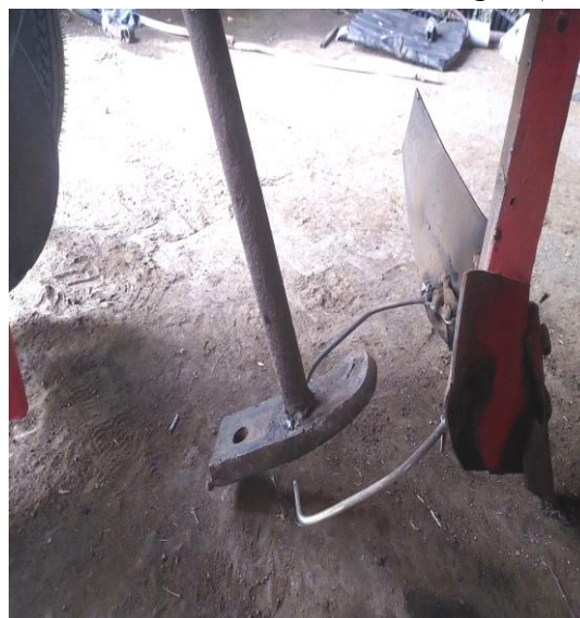
شکل (۳) پوشاننده انگشتی و مسطح کننده خاک Figure (3) Finger covering and soil leveling
