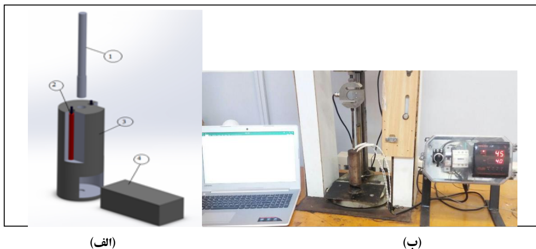
شکل (۱) الف) مکانیزم پلت ساز (۱: پیستون فشار دهنده، ۲: المنت حرارتی دو عدد، ۳: بلوک سیلندر، ۴: پایه نگهدارنده متحرک) و ب) نحوه اتصال آن به دستگاه تست فشار
