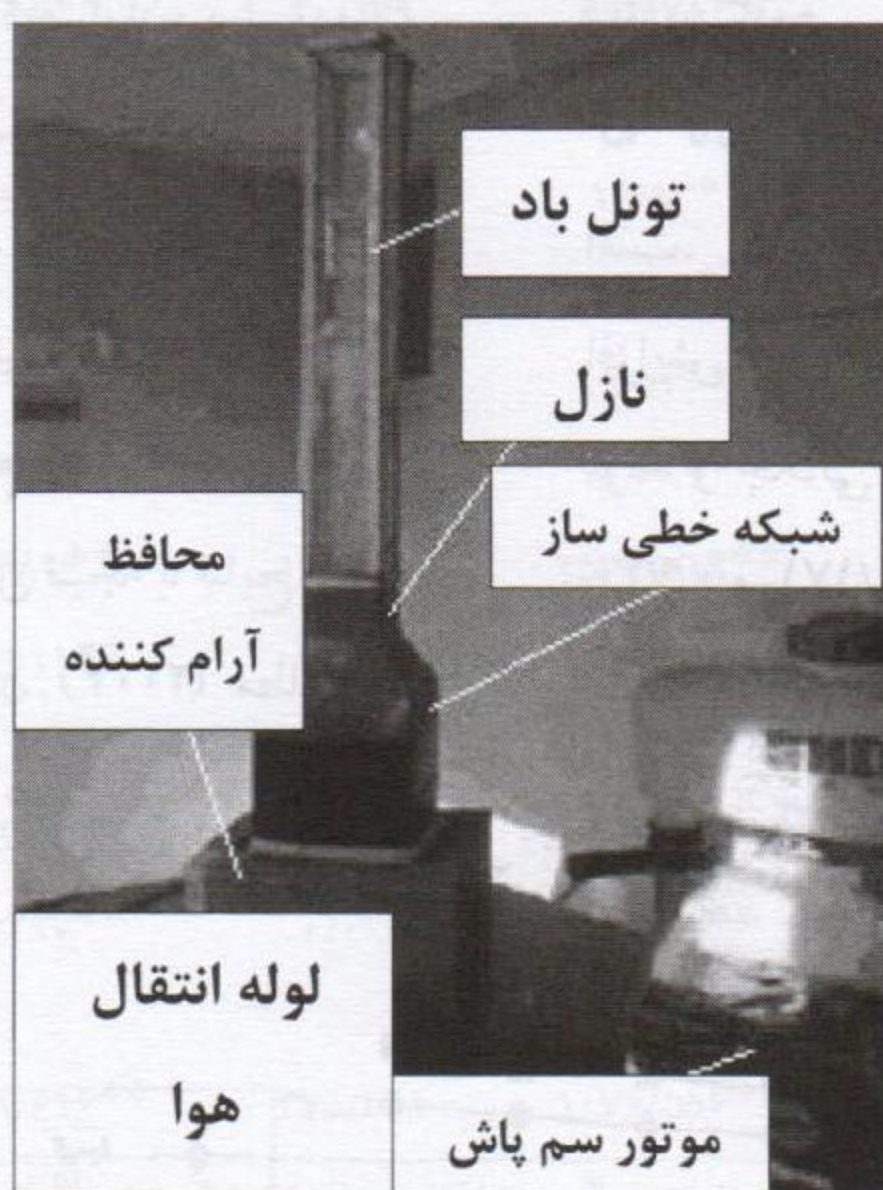
شکل ۲- وسیله ساخته شده برای اندازه‌گیری سرعت حد دانه
