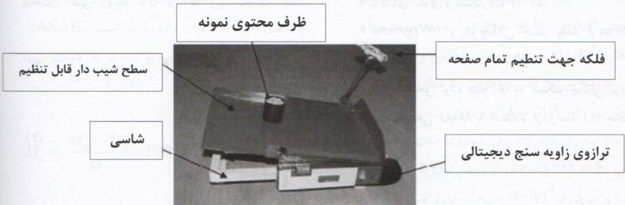
شکل ۱- دستگاه اندازه گیری ضریب اصطکاک استاتیکی
