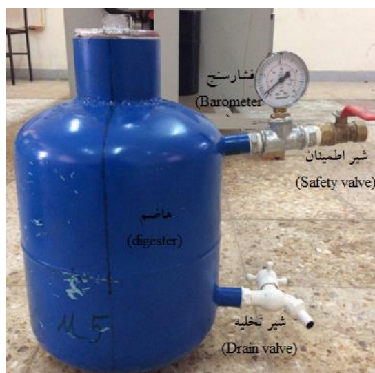
شکل (۱) هاضم استفاده شده (مخزن و تجهیزات کنترل) Figure(1) Used digester (tank and control equipment)
