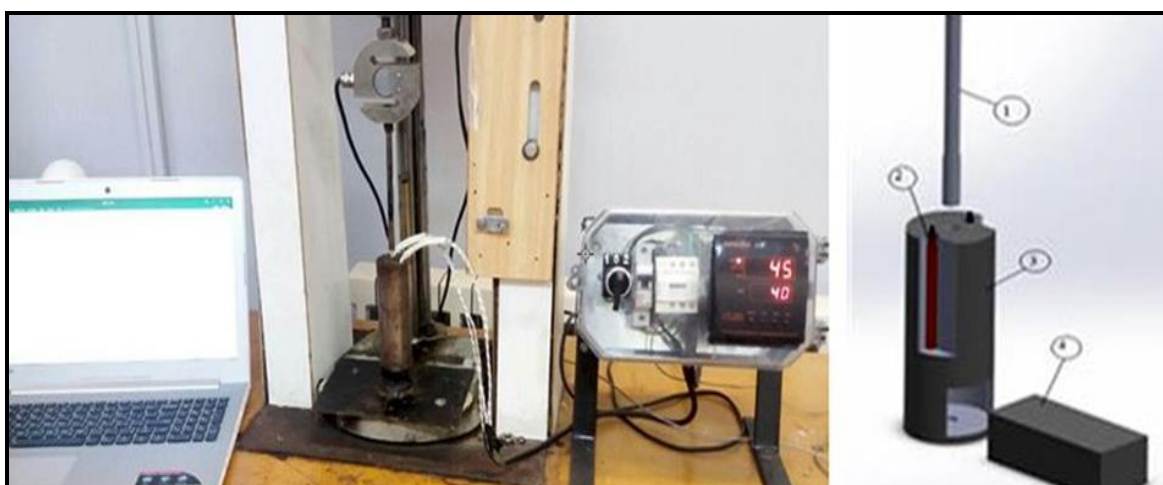
شکل (۱) مکانیزم پلت ساز و نحوه اتصال آن به دستگاه تست فشار (۱) پیستون فشاردهنده، ۲: المنت حرارتی، ۳: بلوک سیلندر، ۴: پایه نگهدارنده متحرک
