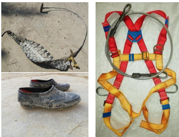
شکل (۱) پروند (سمت چپ بالا)، و کفش لاستیکی (سمت چپ پایین) و هارنس و سیم‌بکسل (سمت راست) Figure (1) Parvand (left-up), elastic shoes (left-down), and harness and towing wire (right)
