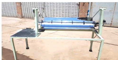
شکل (۱) جمع کننده سهموی خطی Figure (1) Parabolic solar collector
