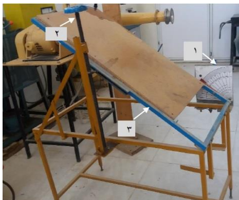
شکل (۲) دستگاه اندازه گیری اصطکاک دانه و سطح
