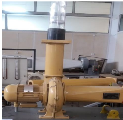
شکل (۳) دستگاه اندازه‌گیری سرعت حد Figure (3) Terminal velocity test rig
