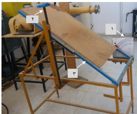
شکل (۲) دستگاه اندازه‌گیری اصطکاک دانه و سطح
