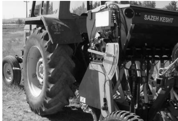
شکل (۵) نصب سامانه پایش بر بذرکار - کودکار (کشت مستقیم) دیم ASKE-2200
