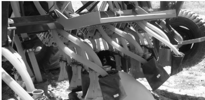
شکل (۸) جمع آوری بذرها ی خروجی از هر لوله سقوط در طول آزمایش مزرعه ای Figure (8) Seed collection from each fall pipe during field experiment
