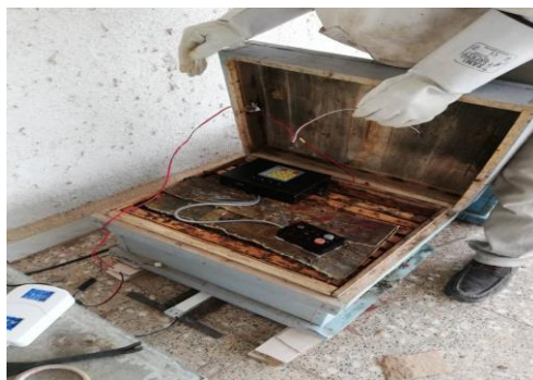
شکل (۱) سامانه اخذ و ثبت داده مورد استفاده در کندوی هوشمند Figure (1) Data Logger of smart beehive
