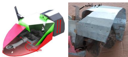
شکل (۵) اهرم تنظیم عمق. Figure (5) Depth adjustment lever
