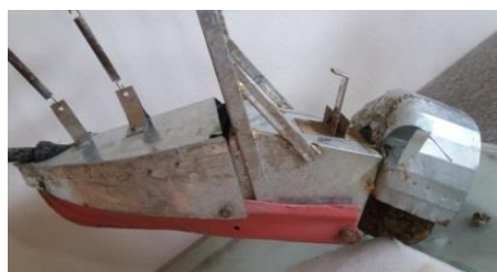
شکل (۳) واحد وجین کن. Figure (3) Weeding unit
