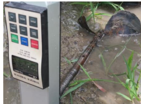
شکل (۶) نحوه اندازه‌گیری گشتاور استاتیکی برای برش خاک.
