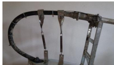
شکل (۲) شافت رابط گردنده با روکش لاستیکی. Figure (2) Swivel interface shaft with rubber overlay
