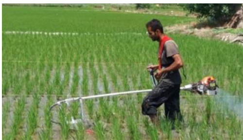
شکل (۱۰) آزمون دستگاه وجین کن (۲۰ روز بعد از نشاء)
