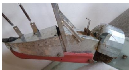
شکل (۳) واحد وجین کن. Figure (3) Weeding unit
