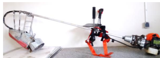
شکل (۹) دستگاه وجین کن ساخته شده
