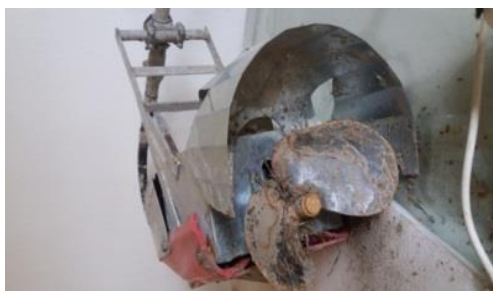
شکل (۴) پروانه واحد وجین کن. Figure (4) Propeller of weeding unit
