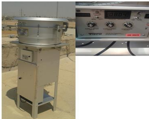
شکل (۲) دستگاه نمونه گیر فعال High Volume Air Sampler مدل RFPS Figure(2) High Volume Air Sampler, RFPS Model
