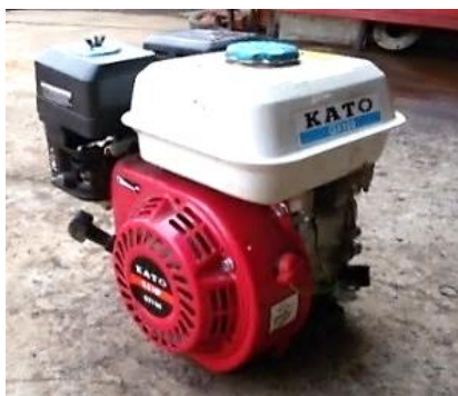
شکل (۲) موتور مورد استفاده در روتوتیلر Fig (2) Engine used in the rototiller
