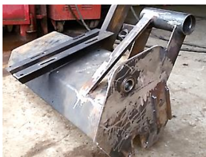
شکل (۶) شاسی مورد استفاده در روتوتیلر
