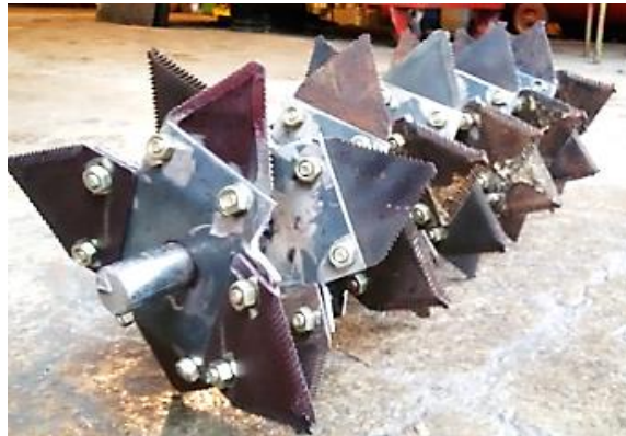
شکل (۴) محور دوار ساخته شده با میله فولادی به قطر ۲/۵ cm
