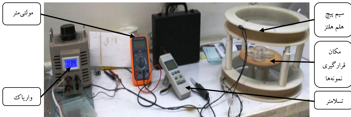
شکل (۳) نحوه چیدمان سامانه کشت الکتریکی Figure (3) Electro culture system arrangement
