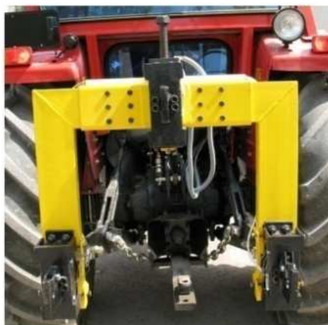
شکل (۲) دینامومتر اتصال سه نقطه قابل تنظیم مورد استفاده در تحقیق
