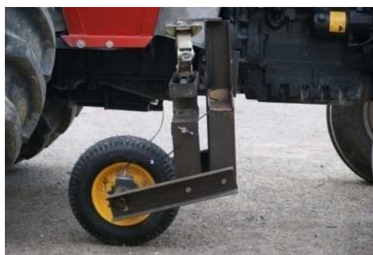
شکل (۳) سامانه اندازه گیری سرعت واقعی تراکتور
