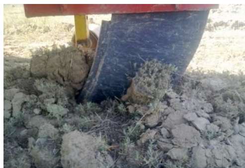
شکل (۴) تیغه باریک مورد استفاده در تحقیق و نمایی از شکست خاک توسط تیغه
