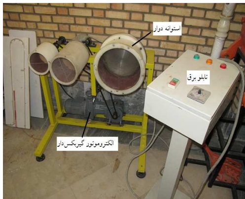
شکل ۱- دستگاه استوانه دوار و اجزای باز شده دستگاه استوانه دوار (قنبری و همکاران، ۱۳۸۷).
