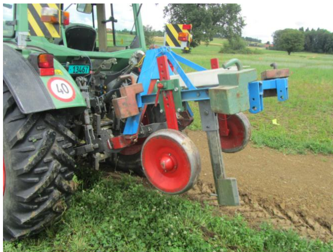
شکل (۱) نفوذسنج افقی تک نوکی مورد استفاده در این مطالعه (۳۴). Figure(1) The single-tip horizontal penetrometer implemented in this study.
