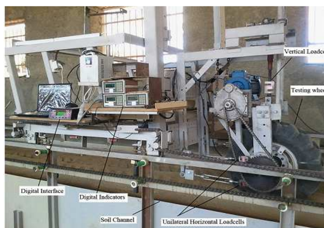
شکل (۱) آزمونگر تک چرخ و انباره خاک مورد استفاده در آزمون‌های تجربی Figure (1) One-wheel tester and soil-bin utilized in experimental tests
